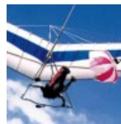
Le drag-chute procure un plus significatif en terme de sécurité lors des phases de retour au sol. Le drag-chute original TECMA ne tourne pas sur lui-même et ne faseje pas. Développé pour les pilotes de compétition, le drag-chute ne réduit pas la vitesse d'atterrissage mais divise la finesse par 2 à 50 km/h, rendant plus aisée la construction d'approche sur petits terrains.
